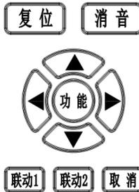
消音：设备及所带探测器出现报警或故障时，喇叭会发出不同的声响，按下“消音”键，消音灯点亮，喇叭会停止发音。
