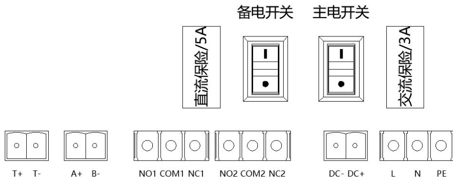
T+ T-: 回路接口, 连接探测器
