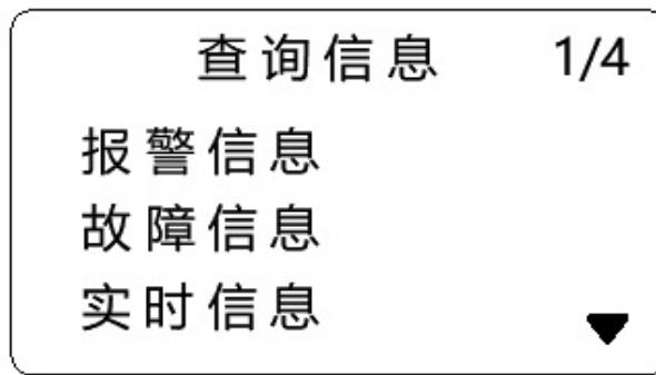
此界面可以查询系统当前的报警信息、故障信息及探测器的实时信息，监控主机的主备电电压信息。
