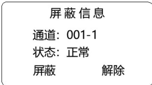
此界面可以将回路中的探测器地址屏蔽掉，不显示在监控主机中。进入密码
