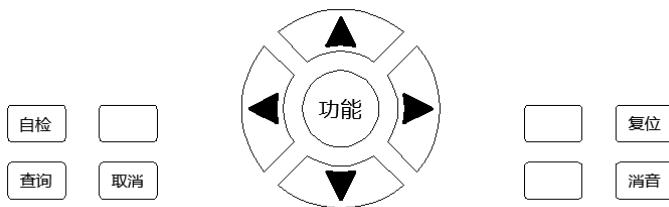
**消音：**设备及所带探测器出现报警或故障时，喇叭会发出不同的声响，按下“消音”键，消音灯点亮，喇叭会停止发音。
