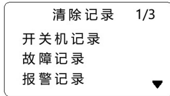
此界面可以将系统存储的开关机记录、故障记录和报警记录删除（无特殊情况不要进行此操作）。进入密码 0911。
